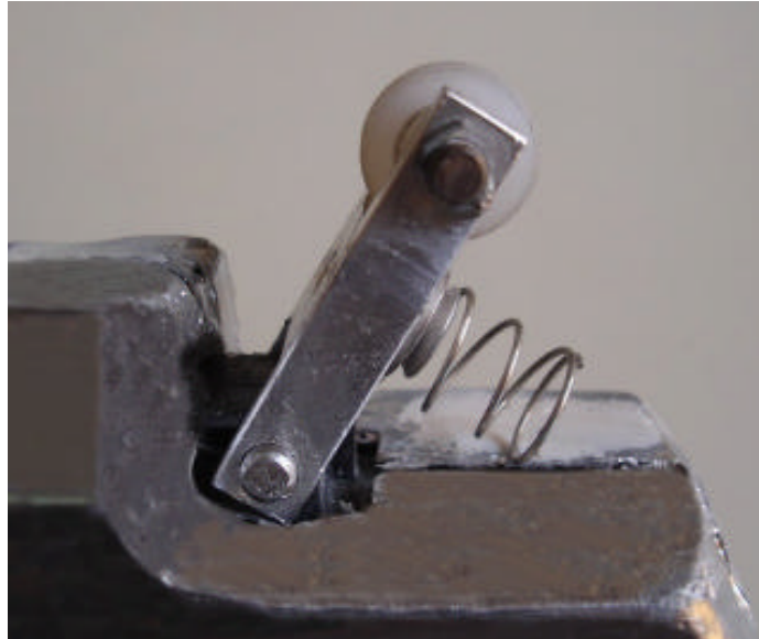
Figura 02: Dispositivo estabilizador com pressão positiva implementado com mola para aumento do contato roda-tubo.
