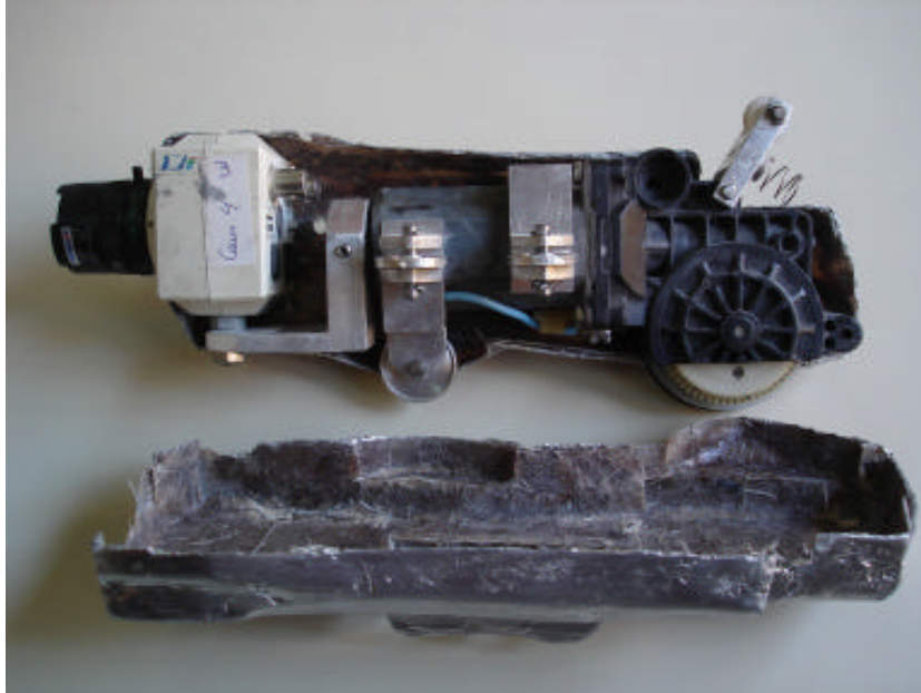
Figura 04: Carenagem em forma de concha para melhor manutenção interna.
